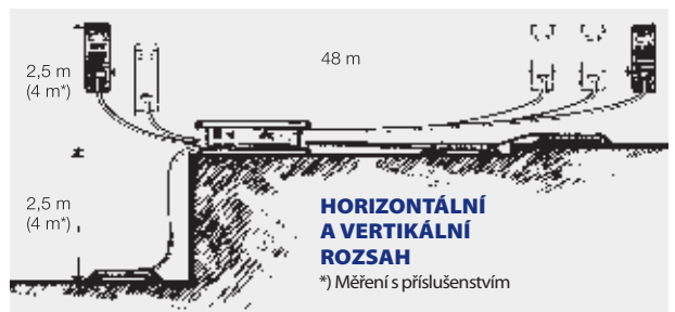
Použití dotykových tyčí při nivelaci stropních bednění (jednoruční nastavení vřetena)
